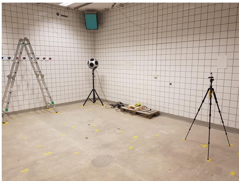
Figur 3.11: Mätning av efterklangstid, stativ vid position närmst den avskiljande väggen.
