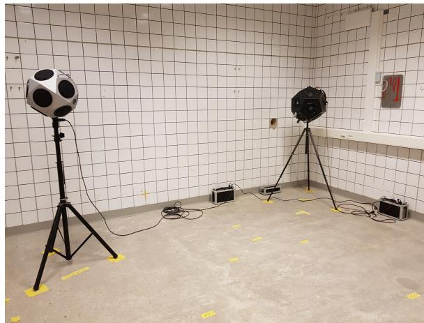
Figur 3.13: Placering av högtalarpositioner i sändarrummet.
