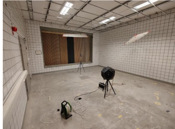
Mätning på en av de fyra vägguppsättningarna i labb.
