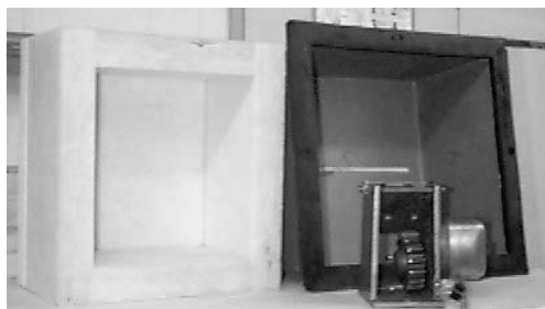
Figur 35 Utrustning för experiment i ljudisolering. Kåporna syns underifrån och maskinen står framför stålkåpan med kugghjul och vipplatta som ljudgenererare.
